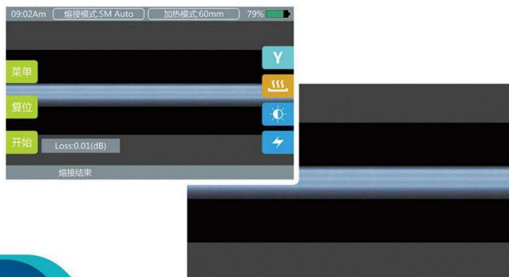
设备有一个简洁明了、便于操作的模式选择菜单。菜单中的各个熔接模式定义了熔接电流、熔接时间、及熔接的各项重要参数。选择合适的熔接模式非常必要。通常的光纤组合熔接模式有一个预定义的数值。这样，可以使许多不常用的光纤组合参数的优化、熔接模式的修改变得容易。
