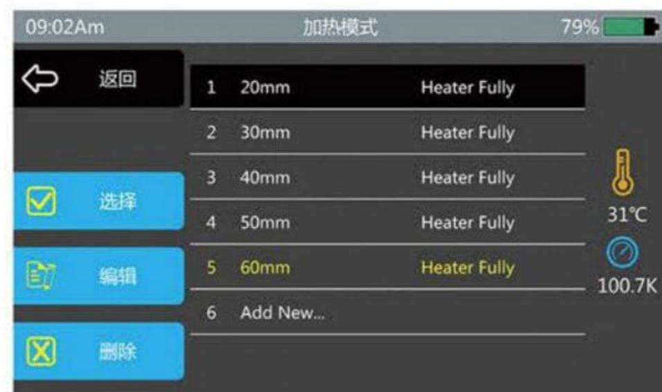
进入【加热模式】选择你要编辑的加热模式，选择【编辑】，进入【编辑加热模式】
