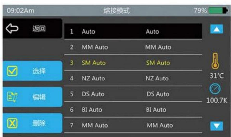
进入【熔接模式】，选择需要的熔接模式后按选择按钮（黄色字体就是当前选择的熔接模式）
