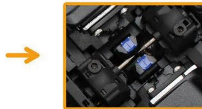
注：请勿沿着V型槽滑动光纤，光纤切面应该超出V型槽位置，但不可以超过电极棒尖端。
