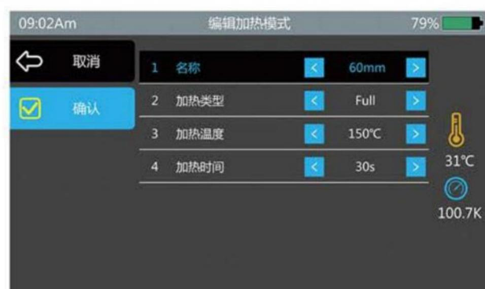
选择你要编辑的参数进行编辑，编辑完毕后，选择【确认】
