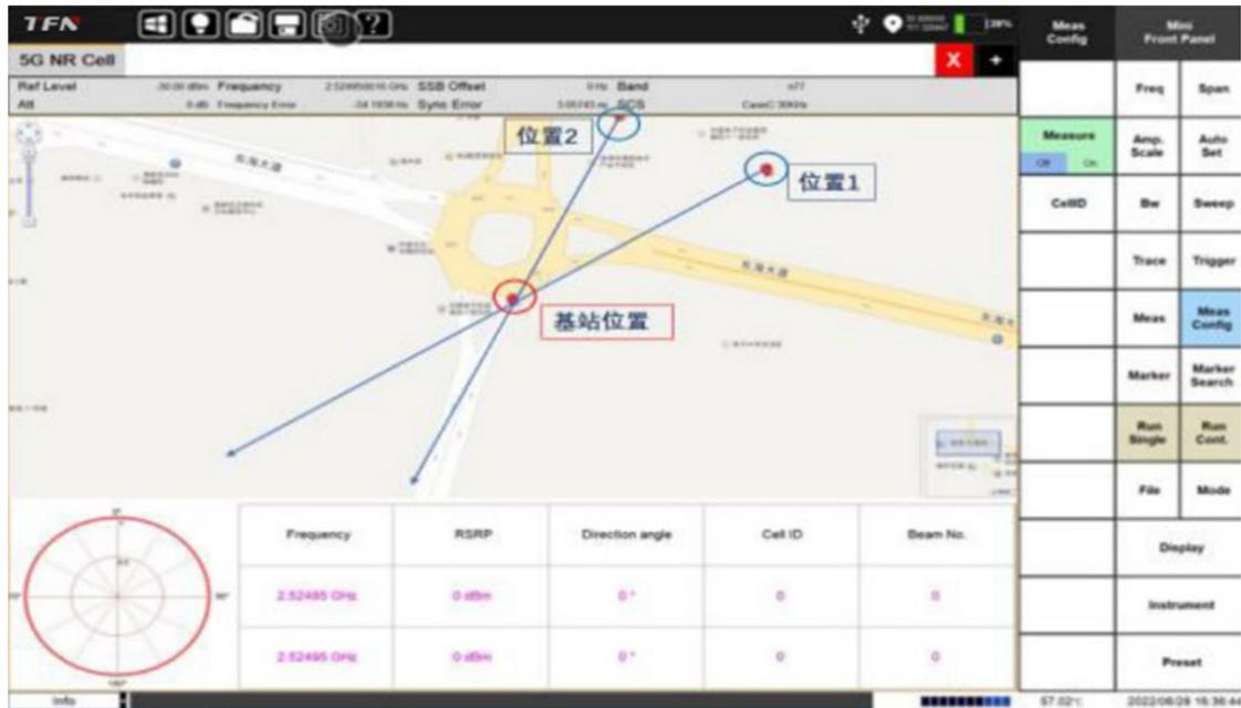
3、5G NR 解调分析，提供 5G Massive MIMO 波束赋型所形成的波束 ID, 小区 ID ; 3S-RSRP ; 3S-RSRQ, SS-SINR 功率指标以及 SSB 星座图和 EVM 等解调指标。
