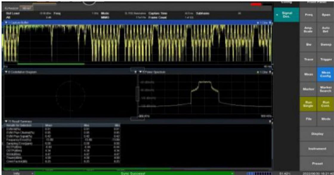
8、支持对 3GPP WCDMA 上行链路和下行链路的带内测量。支持码域功率测量。
